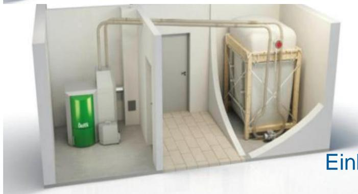
Einbringung mit Tankwagen in max. Entfernung von 25-35 m vom Tankraum
